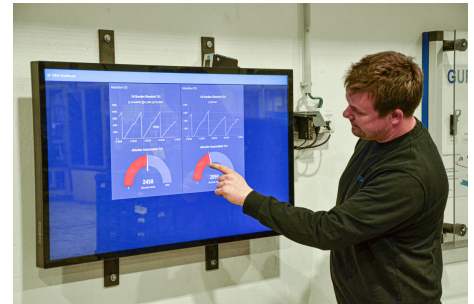
Lider zespołu Jerome Turk prezentuje produkcyjny pulpit nawigacyjny: "Celowo zdecydowaliśmy się na ekran dotykowy, ponieważ pozwala nam on przełączać się na różne widoki stron, przyglądać się bliżej poszczególnym grafikom, a także powiększać widoki, aby na przykład uzyskać wyższą rozdzielczość danych". (Zdjęcie: ipf electronic gmbh)
