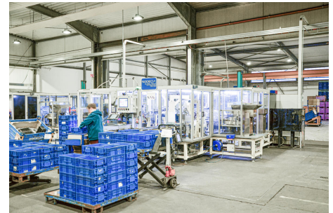
W swoim zakładzie w Attendorn, Sodecia Safety & Mobility zatrudnia około 528 osób i produkuje głównie modułowe elementy poprzeczne do pojazdów elektrycznych oraz zespoły bezpieczeństwa do wnętrza pojazdów. Ilustracja przedstawia obszar produkcji systemów regulacji wysokości pasów bezpieczeństwa. (Zdjęcie: ipf electronic gmbh)
