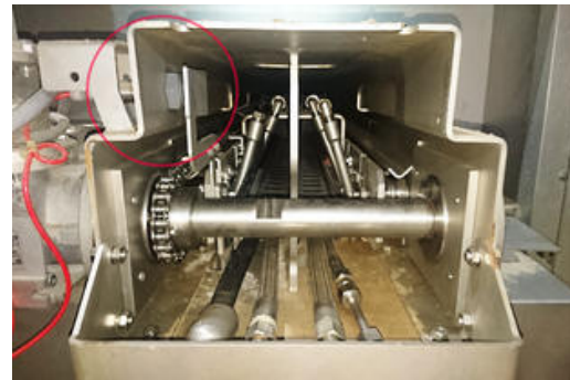
Dwa czujniki indukcyjne IB1201K0 do pomiaru ścieżki i sprawdzania kierunku obrotów są zamontowane przed tarczą kodującą na wale napędowym (po lewej) napędu łańcuchowego. (Zdjęcie: IBS Paper Performance Group)
