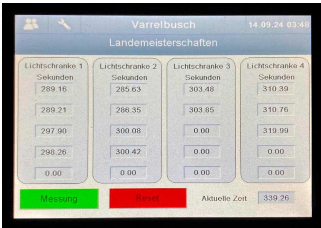
Program PLC został napisany specjalnie do oceny podestów i zaprojektowano małą obudowę ze zintegrowanym panelem dotykowym. Oto wstępny test z wizualizacją czterech barier światlnych.
