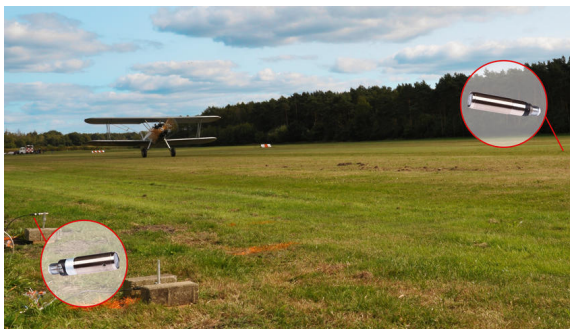
Łądowiska zostały wyznaczone po lewej i prawej stronie wzdłuż pasa startowego za pomocą laserowych barier świetlnych (po lewej odbiornik, po prawej nadajnik) od IPF.
