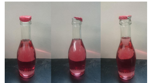
Butelki z wadliwymi zakrętkami dostarczonymi do wstępnych testów. Po prawej stronie wadliwa nakrętka, która jest prawie niemożliwa do rozpoznania zarówno z góry, jak i z boku, w zależności od pozycji w stosunku do systemu kontroli. (Zdjęcia: ipf electronic)
