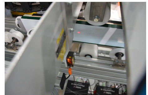
Firma Lechenauer wybrała laserowe skanery światła do precyzyjnego skanowania przedniej krawędzi profilu PT430470 które generują bardzo precyzyjny punkt laserowy dla sygnału wyzwalającego.
