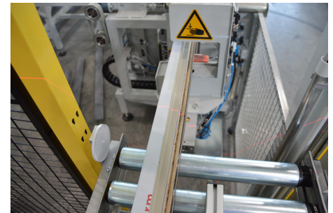
Typy profili są sprawdzane na przenośniku rolkowym. Tutaj profile okienne, które zostały już prefabrykowane w innej maszynie, są automatycznie przenoszone do systemu
